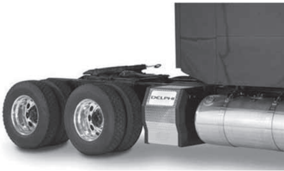
Рис. 4. Батарея ТОПЕ виробництва компанії Delphi, встановлена на вантажному автомобілі
