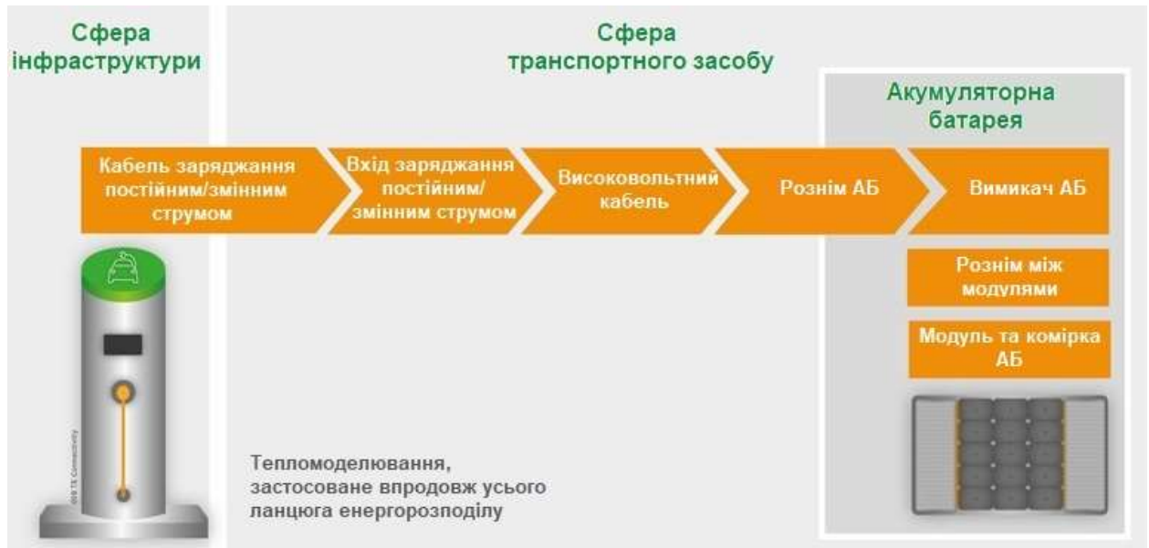
Рисунок 3. Показані по-різному напружені компоненти вздовж ланцюга струму електромобіля (EV).
