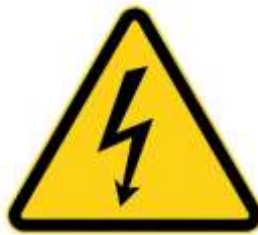
Рисунок 6. Маркування високовольтного обладнання відповідно до пункту S5.4.1.1
